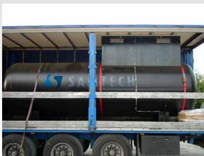
Tank 12.5000 Lt delivery with underground vaporeg Consegna serbatoio da 12.500 Lt. Con vaporeg underground
