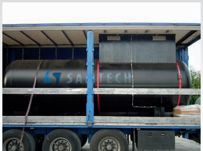
Tank 12.5000 Lt delivery with underground vaporeg Consegna serbatoio da 12.500 Lt. Con vaporeg underground
